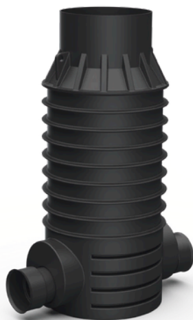
5G z integriranimi priključki za rebraste cevi (obodna togost telesa SN 2)
