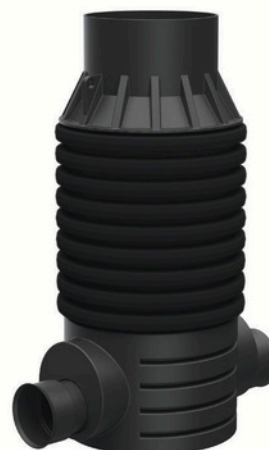
5G z integriranimi priključki za rebraste cevi (obodna togost telesa SN 4, SN 8, SN 10 (rebrasta cev za ID 800 in ID 1000 mm))
