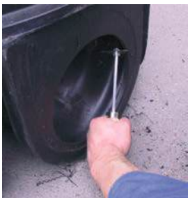
Čiščenje zunanjega in notranjega roba izvrtine
