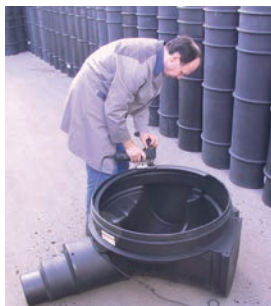
Odrez in čiščenje tehnološkega roba
