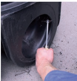
Čiščenje zunanjega in notranjega roba izvrtine
