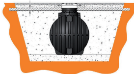
Slika: Montaža greznice pod povozne površine
