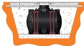
Slika: Podpora greznice z opažem in podpornimi stebri
