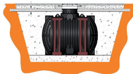
Slika: Potpora septičke jame pomoću oplata i potpornih stupova
