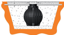
Slika: Ugradnja septičke jame ispod vozne površine
