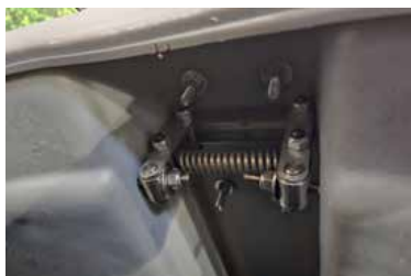
Slika 27: mehanizem za zatezanje inox trakov
