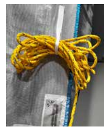
Slika 15: zvitek vrvi vstavite v zanko
