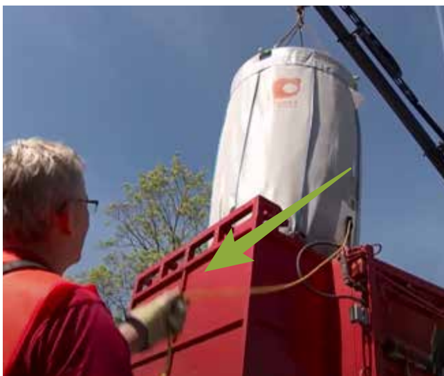
Slika 10: praznjenje vreče s potegom vrvi
