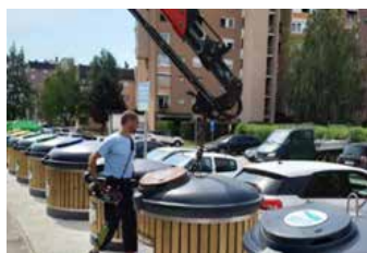
Slika 16: zapnite kavelj dvigala na dvižno prijemalo
