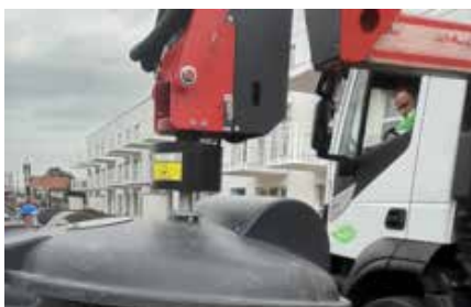
Slika 23: priklop dvigala vozila na dvižni mehanizem posode
