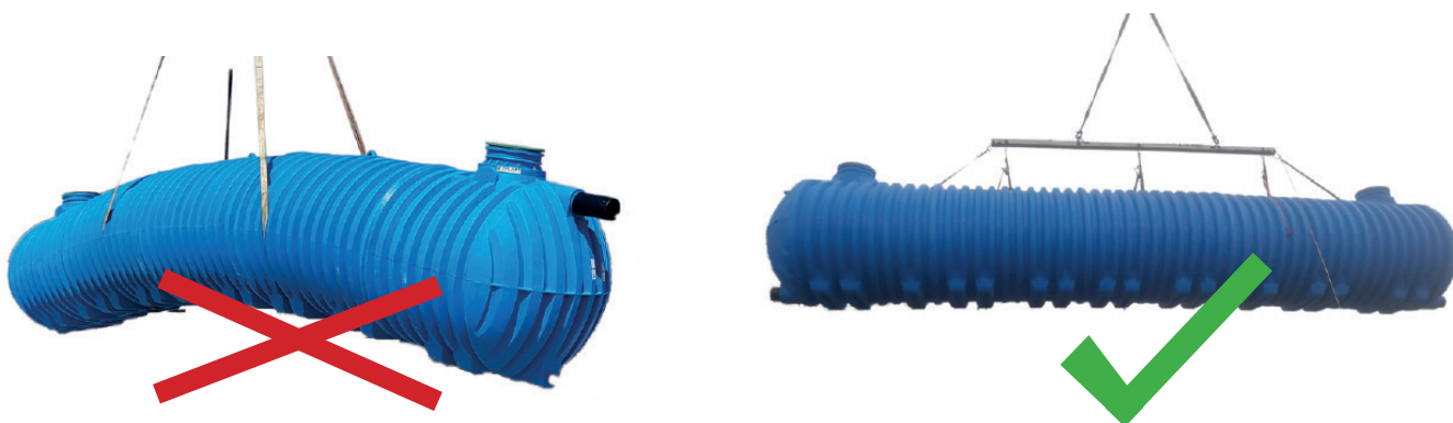
Slika 1: Dvig proizvoda s pomočjo konzole in bremenskih trakov
